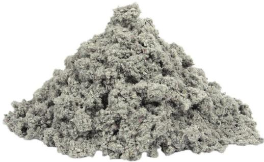
**Zellulose – Dämmstoff wird aus wiederaufbereitetem und zerkleinertem Altpapier hergestellt, z. B. Rollenvor- und -nachlauf aus Druckereien.**
