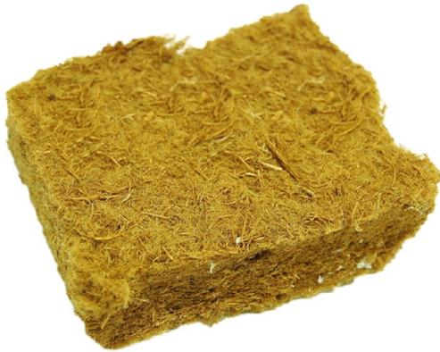
Holzfaserwerkstoffe bestehen zu über 85 % aus Weichholzfasern (Fichte, Tanne, Kiefer), für die heimische Nadelholzabfälle verwendet werden, sowie aus Wasser und Bindemitteln aus Naturharzen bei Holzweichfaserdämmplatten. Bei wetterfesten und stabilen Holzfaserverprodukten wird auch Zement oder Magnesit eingesetzt, feuchtigkeitsabweisende Platten werden mit einer wasserabweisenden Ausrüstung versehen (Hydrophobierung) bzw. mit Latex oder Bitumen überzogen.
