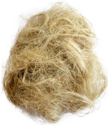
Flachsplatten, -filze oder -vliese werden aus der traditionellen mitteleuropäischen Flachspflanze hergestellt. Flachs ist also ein Produkt aus heimischer Landwirtschaft. Bei ca. 200 °C kommt es zu einer Volumenabnahme von etwa 4 %, ab ca. 260 °C treten Verfärbungen auf. Bei höheren Temperaturen verkohlt Flachs.
